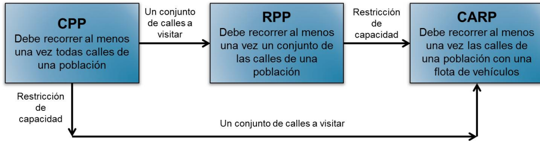
Figura 2.5: El RPP es un CPP con la restricción de que debe visitar solamente un conjunto de calles, el CARP es un RPP con restricción de capacidad y de igual manera el CARP es un CPP con ambas restricciones (capacidad y un conjunto de calles a visitar).
