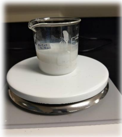
Figura 20. Adición de NaOH, la solución policondensa formando un gel de color blanco.
