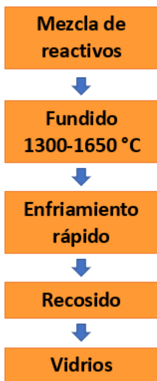
Figura 6. Esquema general de la obtención de los vidrios bioactivos por el método de fusión [31].
