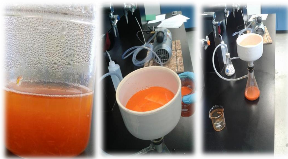
Figura 24. Obtención y filtrado del extracto de Daucus carota (zanahoria).
