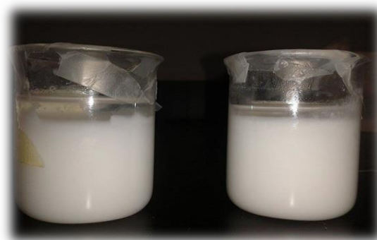
Figura 22. Envejecimiento del gel durante 13 días y el polvo obtenido una vez secado en microondas y pulverizado en el mortero de ágata.
