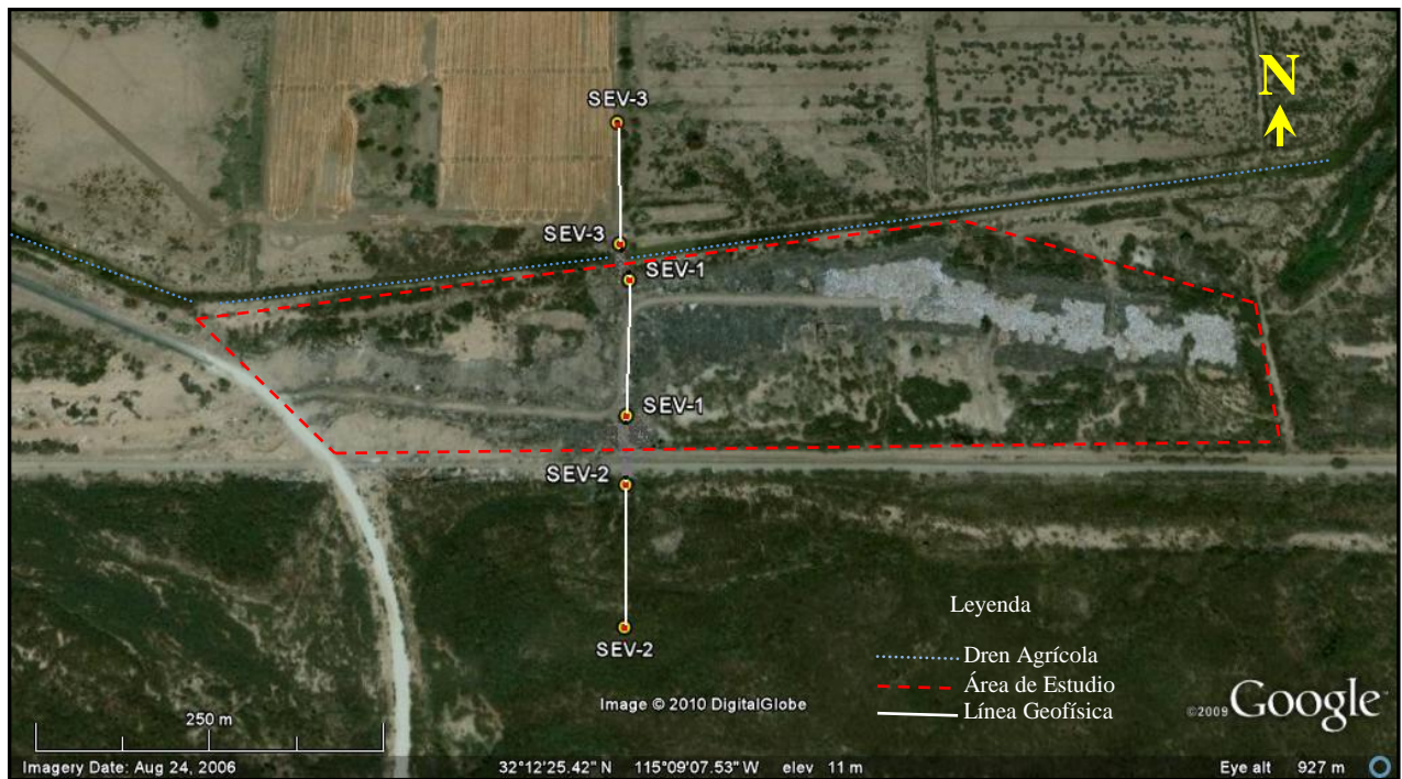
Figura 12. Ubicación de líneas Geofísicas S1-I (Primer Sondeo-Inicio), S1-E21 [S2-I](Primer Sondeo-Electrodo 21 y Segundo Sondeo-Inicio), S1-F (Primer Sondeo-Final).
