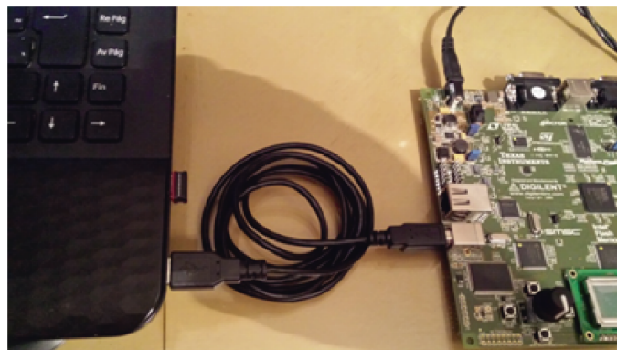
(b) Conexión entre la PC y la FPGA por medio del puerto USB, usando el protocolo JTAG.
