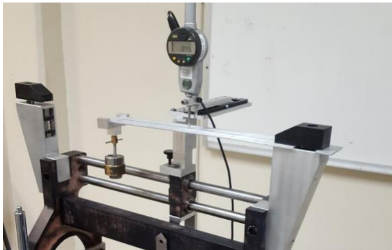
Figura 28. Espécimen sometido a empotramiento y carga.
