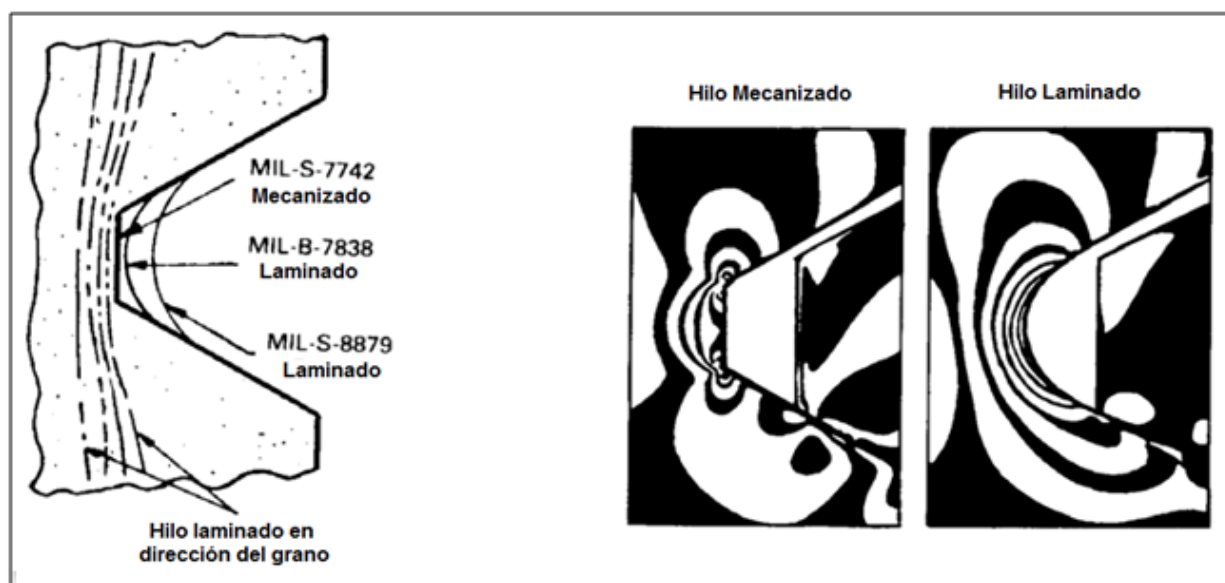
Figura 2.20 Comparación entre roscas mecanizadas y laminadas [23].
