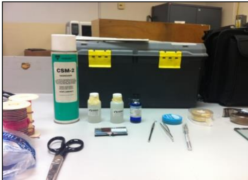
Figura 3.20 Material para la instalación de galgas extensiométricas.
