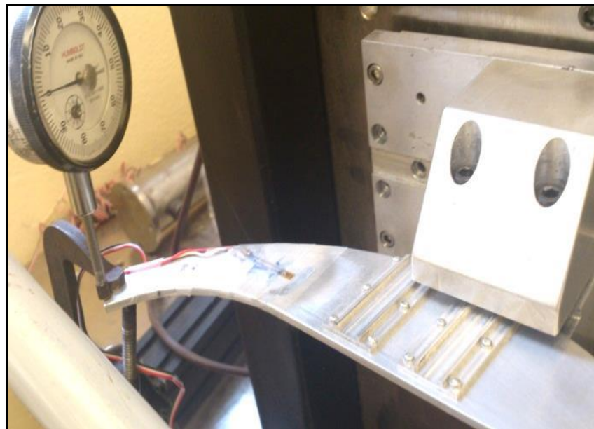
Figura 4.7 Montaje de pieza aeroespacial en banco de pruebas para Prueba 2.
