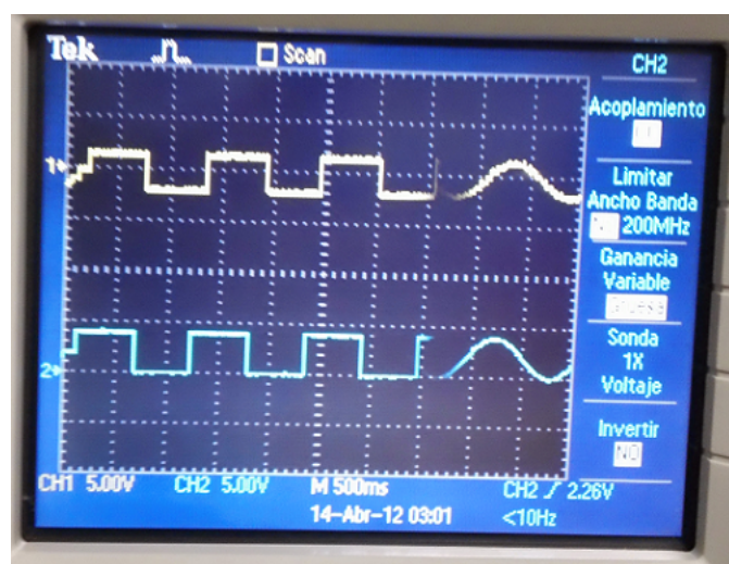
Figura 36: Cambio abrupto de tipo de señal.
