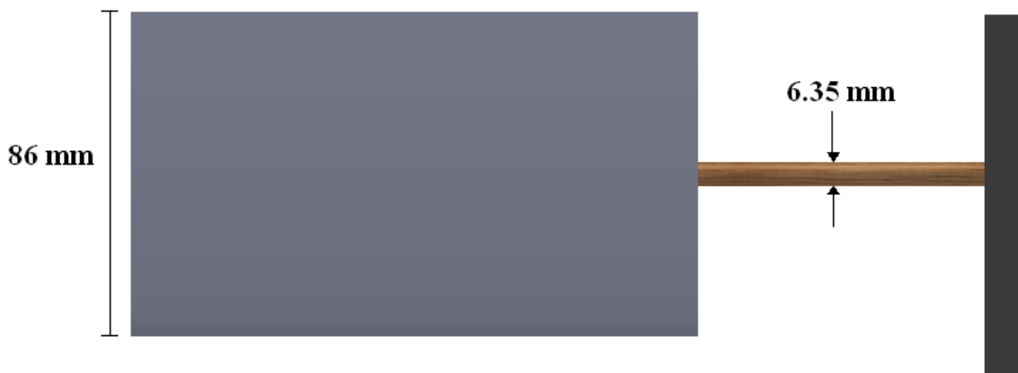
Figura 3.69 Medidas reales de la cuerda del perfil y de la barra de apoyo (Superior).
