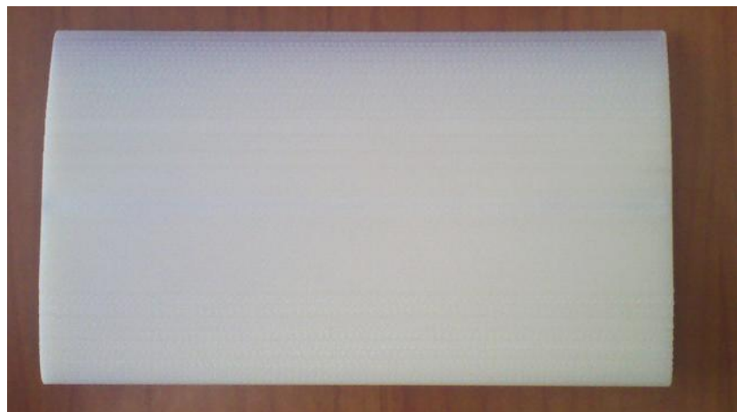
Figura 3.64 Perfil BAC J adecuado a un ala recta.
