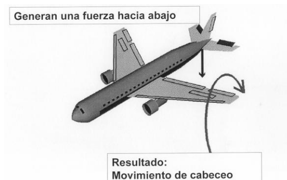
Figura 2.14 Control con el timón de profundidad
