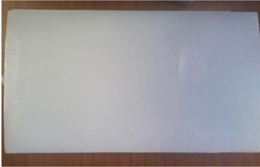
Figura 3.77 Ala recta de perfil BAC J con acabado superficial.
