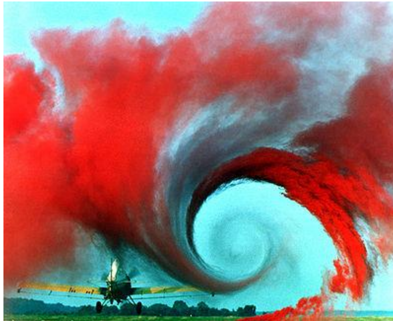
Figura 1.1 El paso del ala de un avión crea un vórtice identificable por el humo coloreado
