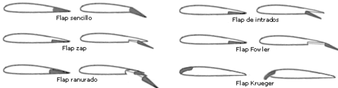
Figura 2.11 Tipos de flaps
