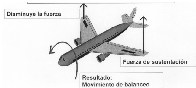
Figura 2.18 Control con los spoilers
