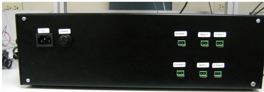
Figura 4.2. Foto de la parte trasera del chasis de la etapa de potencia.
