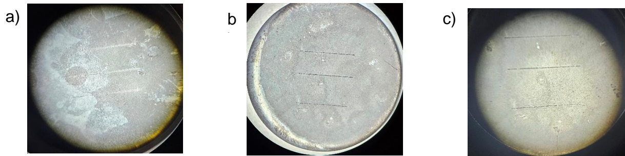
Figura 4.36 Desgaste de placa del aceite base con a) GS1, b) GS2 y c) GS3
