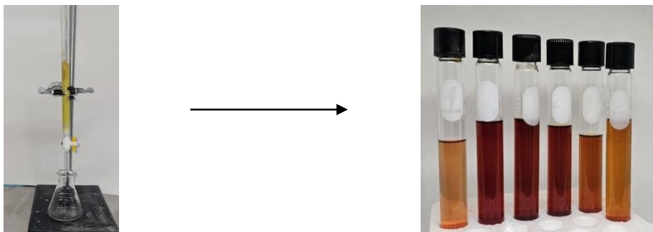
Figura 4.25. Fracciones extrahidas de la columna de cromatografía del compuesto 1,1butano-di 2-fenil-bencimidazo.
