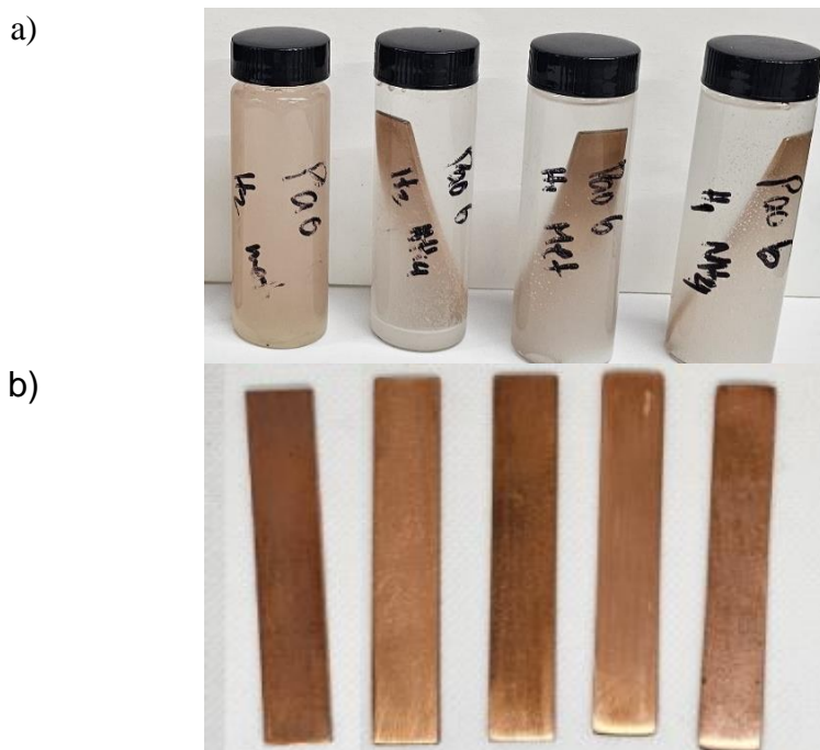
Figura 4.29 a)Modificación de la ASTM D 4048 y b) placas obtenidas
