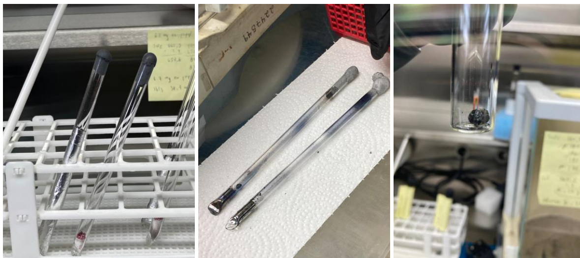
Figura 17. Ámpulas con precursores CsI y \text{SnI}_2 mezclados dentro de la cámara de gas (izquierda); ámpulas con cristales de \text{CsSnI}_3 ingresados a la cámara de gas después del tratamiento térmico (centro); cristal de \text{CsSnI}_3 recuperado al quebrar las ámpulas (derecha).
