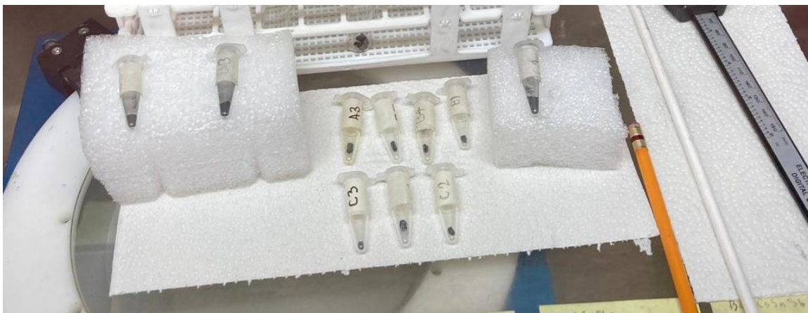
Figura 26. Cristales con forma de barra en tubos Eppendorf (centro); tubos Eppendorf con muestras pulverizadas en el mortero de cuarzo (extremos izquierdo y derecho).
