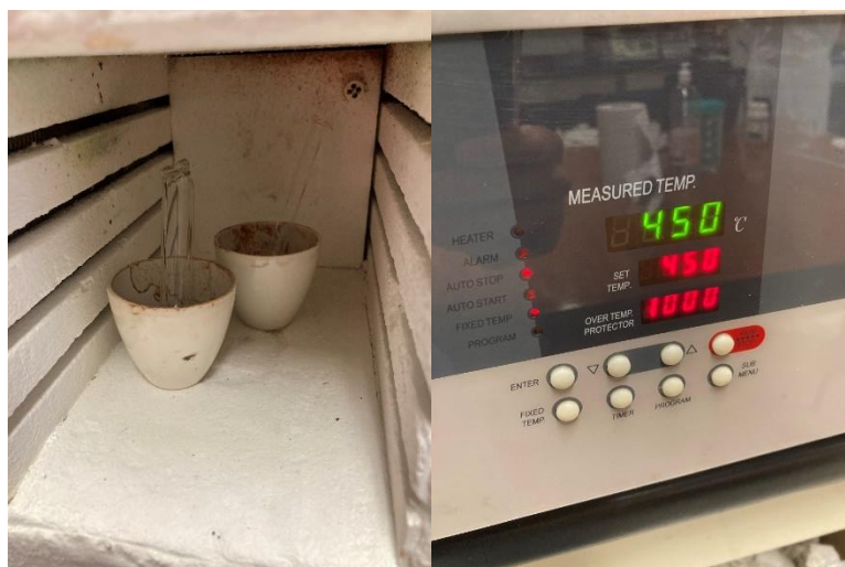
Figura 16. Crisoles con tubos de prueba (izquierda); caratula y control de parámetros del horno utilizado para el tratamiento térmico (derecha).
