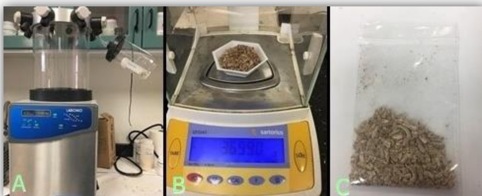
Figura 6. Fotografías tomadas a: A. Liofilizador ubicado en el Laboratorio de Nutrición Acuícola en la FCM; B. Peso de lombriz en peso seco; C. Lombriz seca por medio de liofilización.
