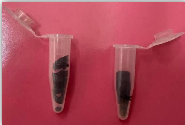
Figura 7. Fotografía tomada a tubos eppendorf con contenido de harina de lombriz secada por medio de liofilización.
