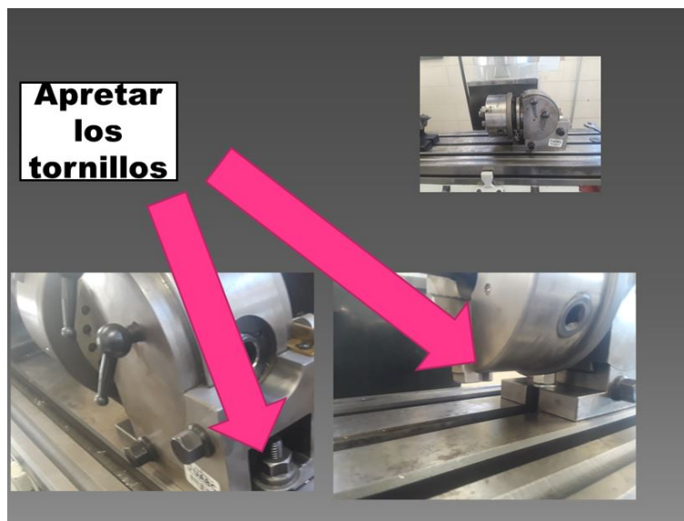
Figura 3.10: Ubicación de tornillos de 7/8" que sujetan la base del cabezal
