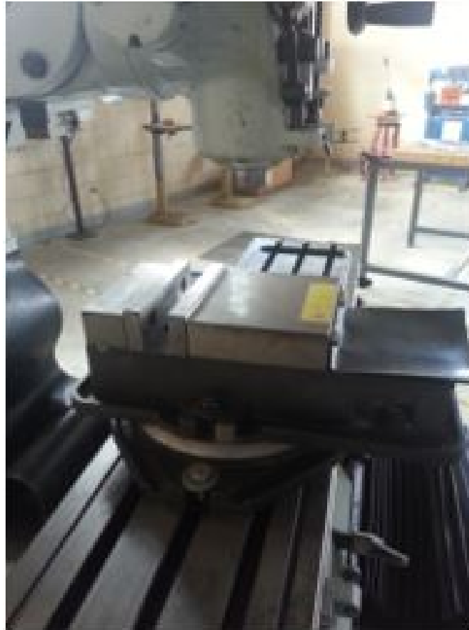
Figura 2.15: Prensa colocada en la fresadora
