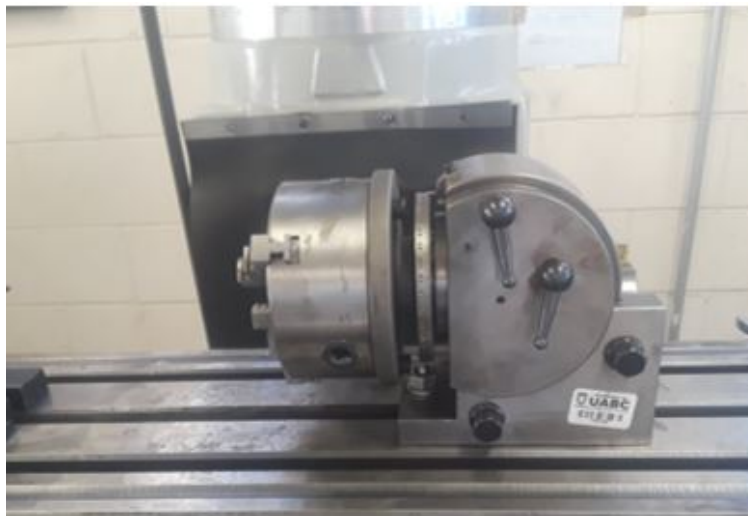
Figura 3.8: Colocación de cabezal divisor en fresadora
