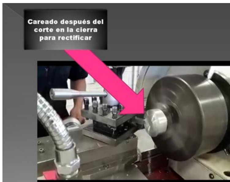
Figura 3.7: Maquinado de la parte posterior de la pieza
