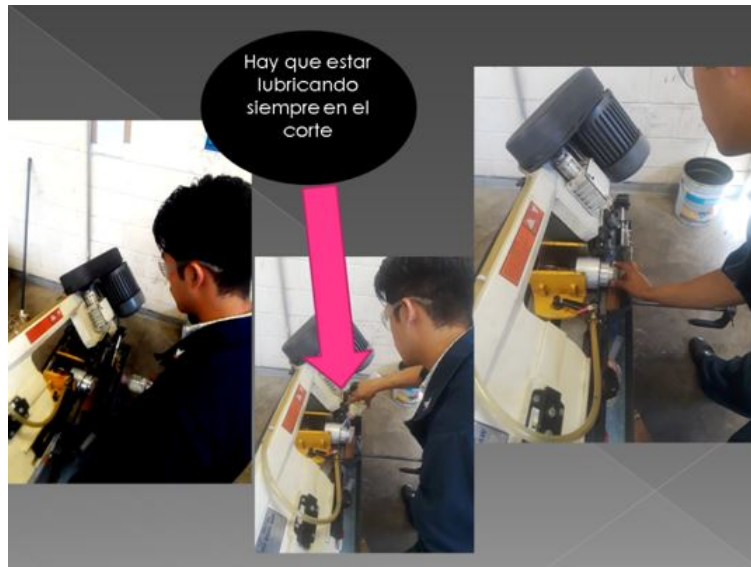
Figura 3.6: Corte de pieza semi-terminada
