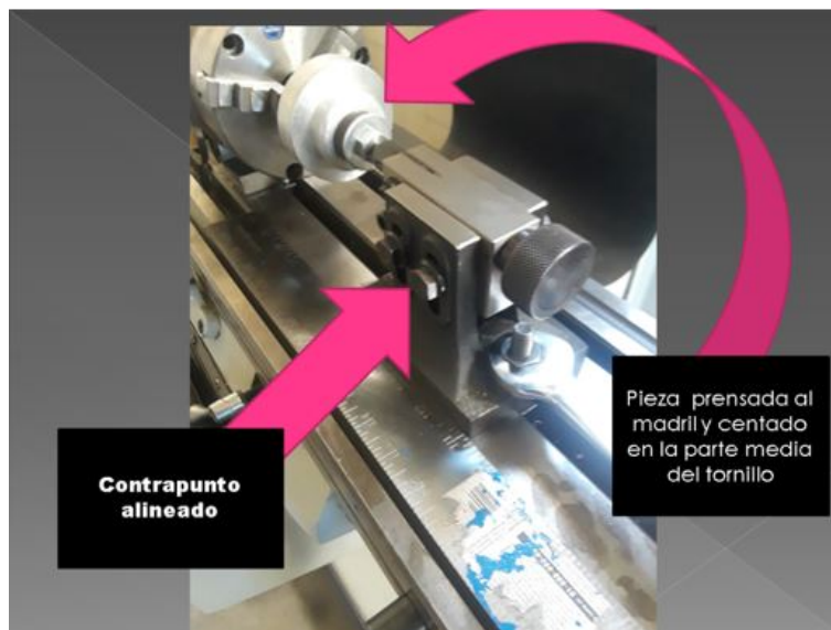
Figura 3.12: Montaje de pieza en cabezal divisor.
