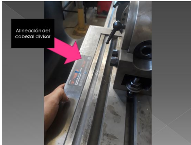
Figura 3.9: Alineación de cabezal divisor
