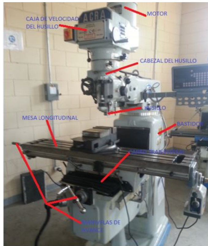
Figura 2.14: Partes de una fresadora
