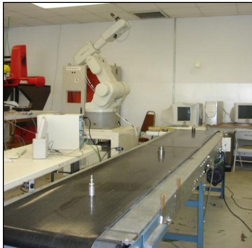
Figura 8. Sensores fotoreflexivos en banda transportadora
