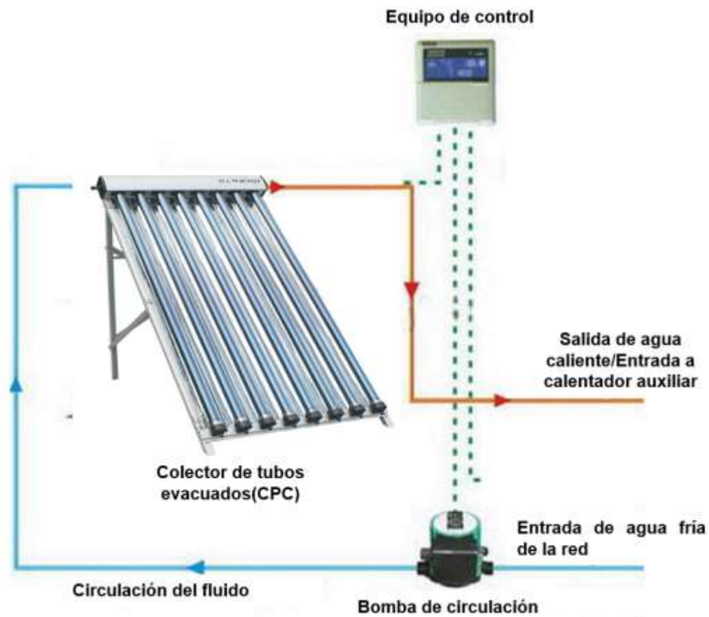
Figura 35. Diagrama esquemático de un sistema solar para calentamiento de agua con tanque de almacenamiento.
