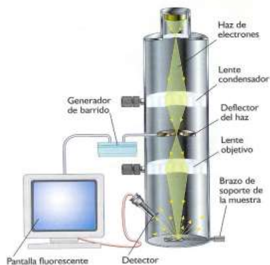
Figura 15. Esquema de un microscopio electrónico de barrido (EcuRed, 2013).
