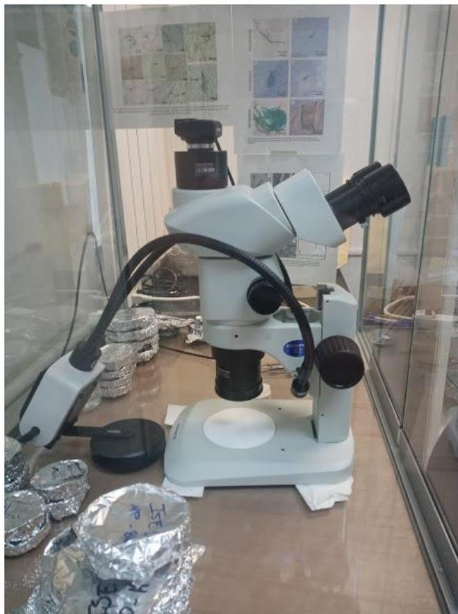
Figura 11. Microscopio estereoscópico Olympus SZX7 (70X) dentro de una cabina de cristal, utilizado para la cuantificación de MPs.
