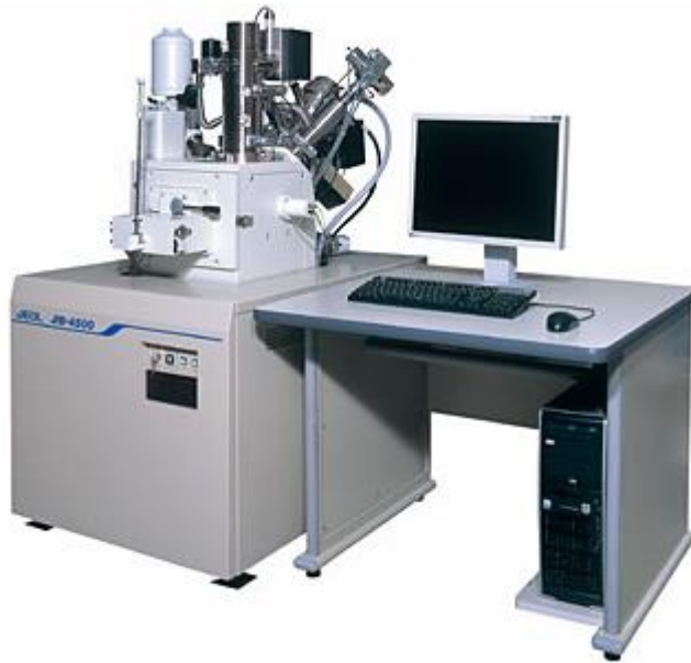
Figura 13. Sistema integral de microscopía electrónica (SEM) y haz de iones enfocados (FIB) modelo JEOL JIB-4500.
