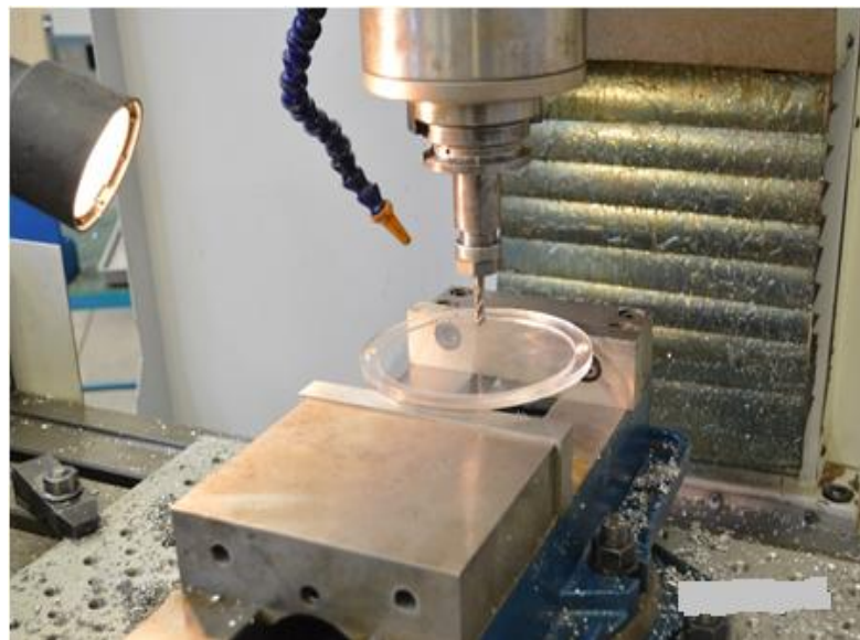
Figura 2.5 Maquinado en fresadora CNC, taladrado de barreno del centro de la pieza.
