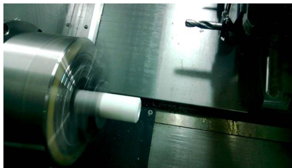
Figura 2.7 Barreno de centro \phi=4.8 mm
