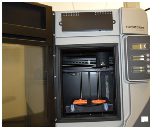
Figura 2.11 Impresión de modelos en impresora 3D FORTUS. 250mc.
