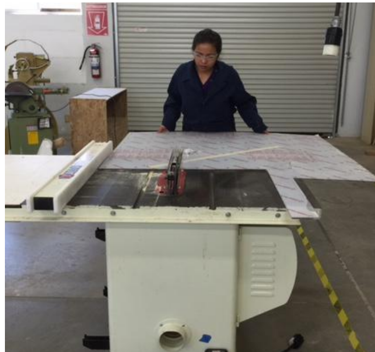
Figura 2.4 Corte de acrílico en sierra de mesa.
