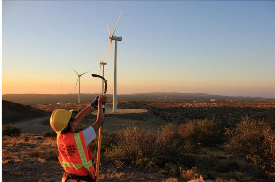
Figura 6. Instalación del equipo de monitoreo acústico. Fotografía de Aldo Guevara©
