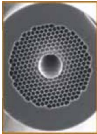
Figura 4. Estructura transversal de PCF de núcleo hueco. Imagen tomada de P. J Roberts et al (2005) [15].
