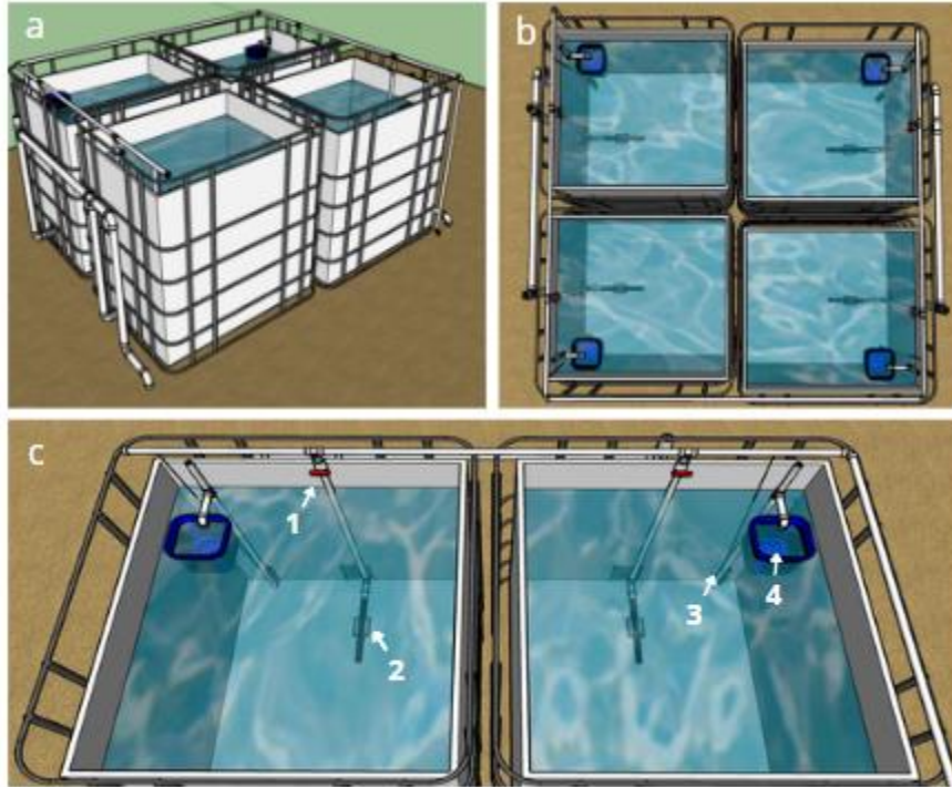
Figura 4. Tanques experimentales. a. Sistema experimental compuesto por cuatro tanques de 1,000 L. b. Vista área del sistema experimental. c. Componentes del sistema. 1, entrada de aire al sistema; 2, parte del sistema de aireación equipado con manguera difusora de aire; 3, Sistema airlift; 4, filtro mecánico para sólidos utilizando relleno sintético.
