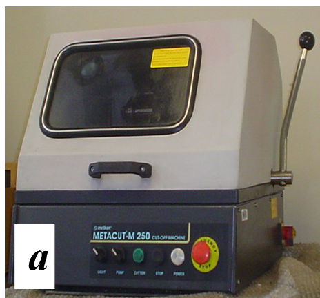
Fig.3.17 Cortadora de disco Metacut-M 250 (a) y microscopio trinocular (b).
