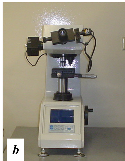
Fig.3.21 Prensa Tinius Olsen modelo H 25K-T8 (a) y microindentador digital modelo HVS-1000 a (b).
