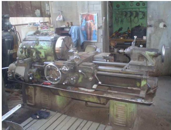
Fig.3.16 Torno paralelo manual Monarch modelo 16" W
