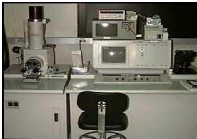
Fig.3.20 Microscopio electrónico de barrido Hitachi modelo S-2400.
