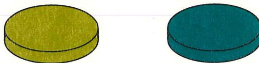
Figura 2.4: Se muestra el color que tiene el material a temperatura ambiente y el color que presenta al ponerlo en contacto con bajas temperaturas.
