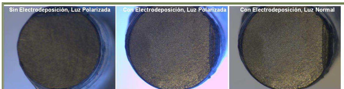
Figura 26. Imagen bajo luz polarizada y normal del electrodo de grafito antes y después de la electrodeposición en solución diluida al 10%.
