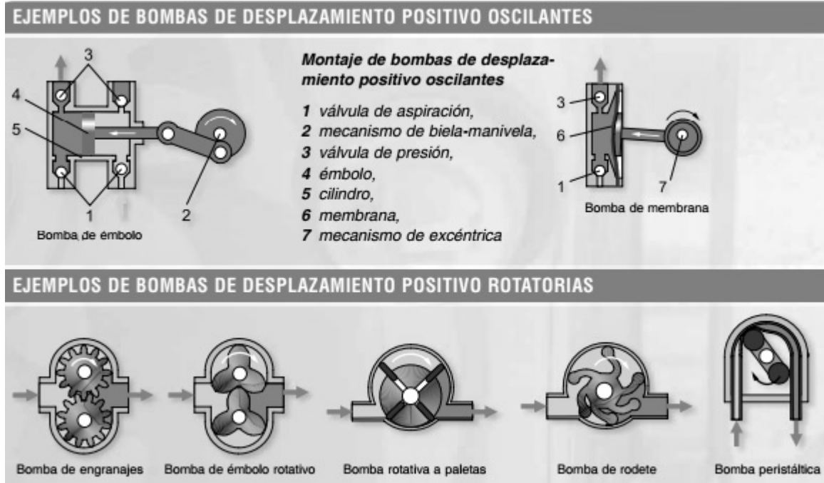
Figura 2.8: Bombas de desplazamiento positivo (por cortesía de G.U.N.T.)
