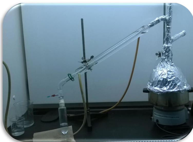
Fig. 27 Sistema Clevenger modificado., extracción de aceite esencial de C. coronarium
