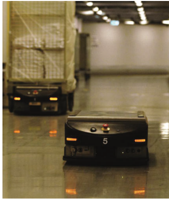
Figura 3.2: Dos AGV de carga unitaria, a la izquierda uno cargado y a la derecha uno sin carga [8].
