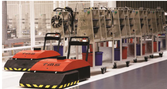
Figura 3.1: Un AGV de remolque transportando carros hacia una línea de producción [8].
