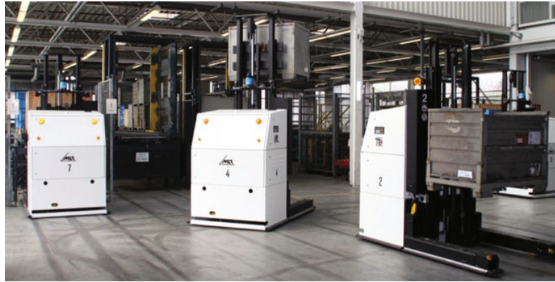
Figura 3.4: Tres AGV tipo montacargas de la flotilla de Deutz [8].
