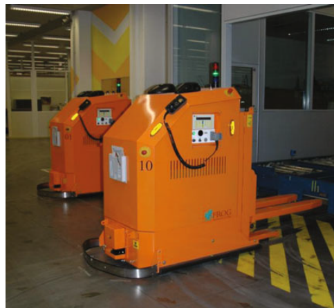
Figura 3.3: AGVs de tipo transpaleta en un almacén [8].
