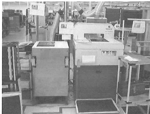
Figura 2.43 Sistema Scan Fluxer y Spot Dip Selectiva
