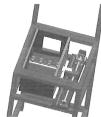
Figura A - 02 Colocación de la caja de acero inoxidable.
