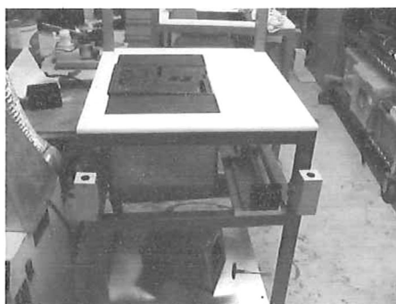
Figura 2.41 - f Scan Fluxer (vista superior y mascara placa QMQI 2004)
