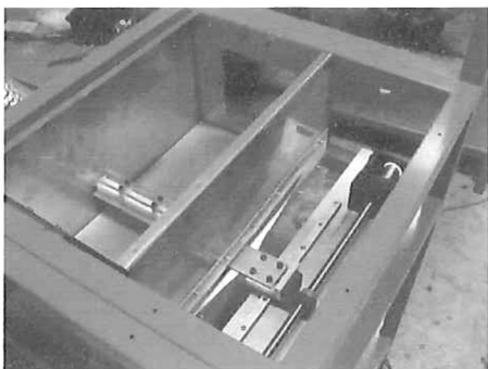
Figura 2.41 - c Boquillas dispersoras de Flux y montaje en el equipo
