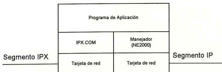
Figura 30.- Organización interna del nodo pc-pruebas.
