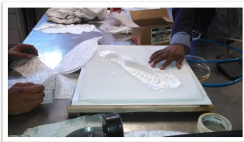
Fig. 4.25. Aplicación de las capas de fibra de vidrio.
