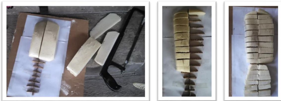
a) c) d) Fig. 4.18. Ensamble de la espuma y del esqueleto, a) cortes realizados en la espuma, b) ensamble parcial sobre puesto y c) ensamble final sobre puesto.
