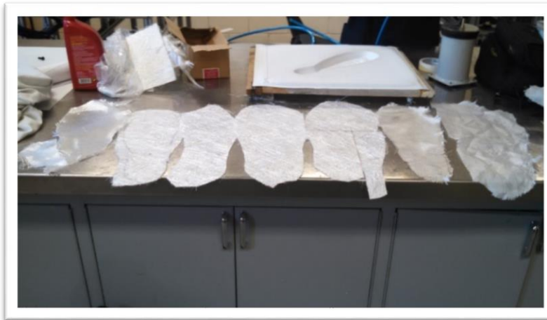
Fig. 4.24. Capas aplicadas en la fabricación del material compuesto.
