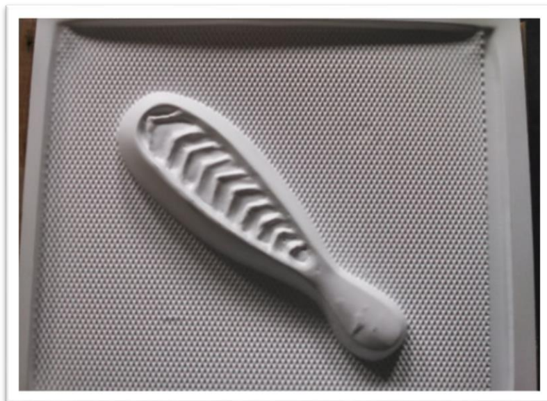
Fig. 4.23. Molde obtenido por medio del termoformado de estireno calibre 30.
