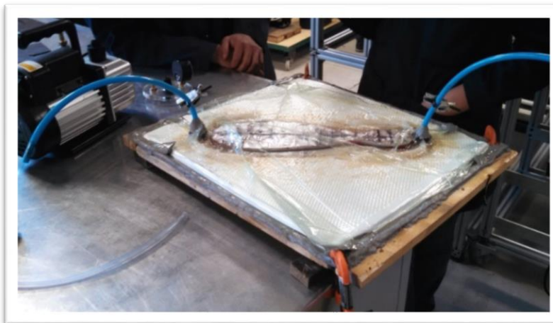
Fig. 4.27. Proceso de infusión y aplicación de la resina.
