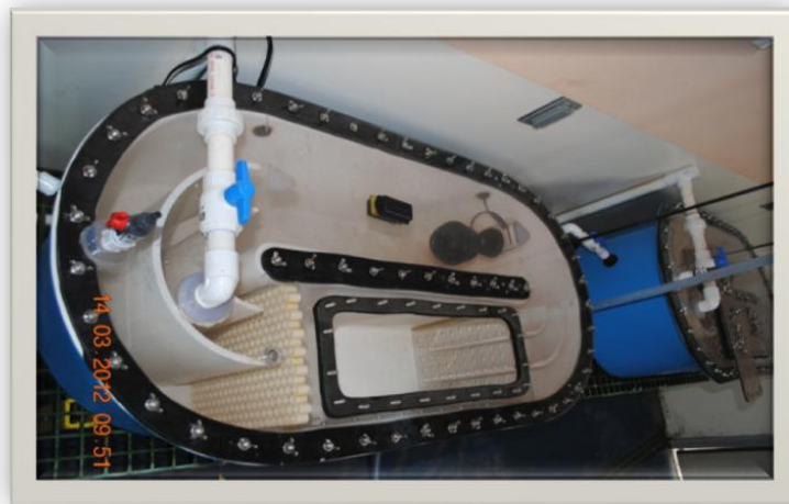
Figura 2.- Cámara respirométrica para determinar el consumo de oxígeno y la excreción nitrogenada de organismos acuáticos
