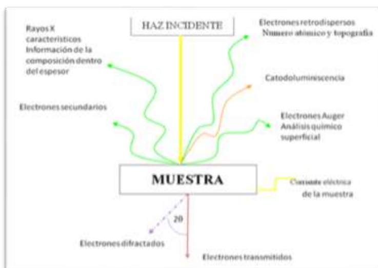
Figura 25. Señales generadas por la interacción de una haz de electrones de alta energía y la muestra.
