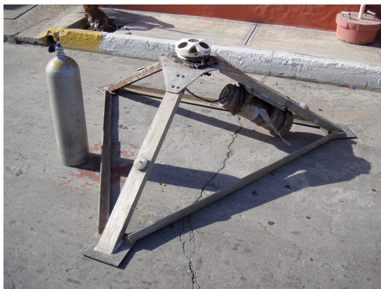
Figura 2-2 Estructura y equipo en el cual esta montado el perfilador acústico de corrientes AWAC.
