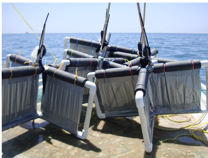
Figura 2-3 Boyas de deriva con GPS integrado.
