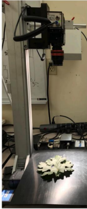
Figura. 6. Sistema de imágenes hiperespectrales de Gao, Z, et al, 2020.
