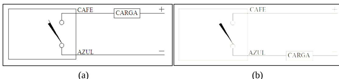
Figura 4.8. Opciones de conexión N.A del sensor Honeywell MICRO SWITCH 926AA3XM; (a) conexión tipo sinking, (b) conexión tipo sourcing.
