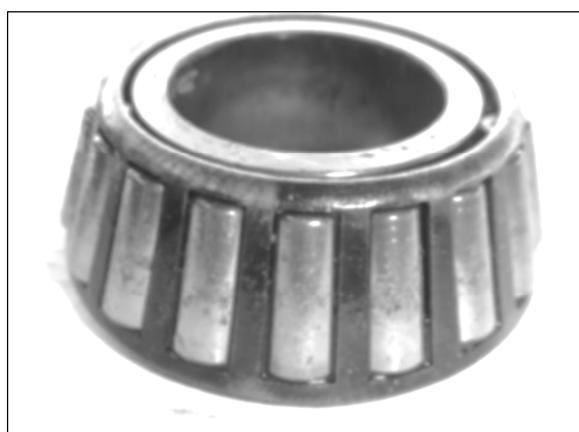
Figura 5.15. Condición real de los componentes de la jaula y los rodillos del rodamiento del espécimen B.
