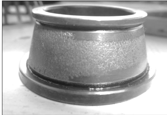
Figura 5.16. Condición de falla real de la pista interna del rodamiento del espécimen B.
