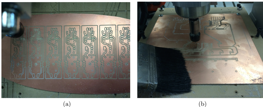
Figura 4.28: Grabado de las placas de las etapas de acondicionamiento y módulo genérico de monitoreo y control.
