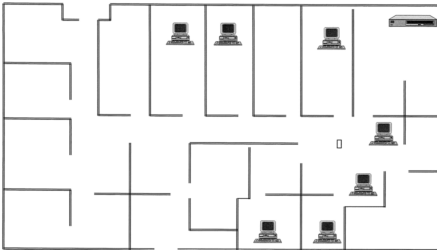
Fig. 19.- Nodos activos al final de la instalacion en la sala de maestros
