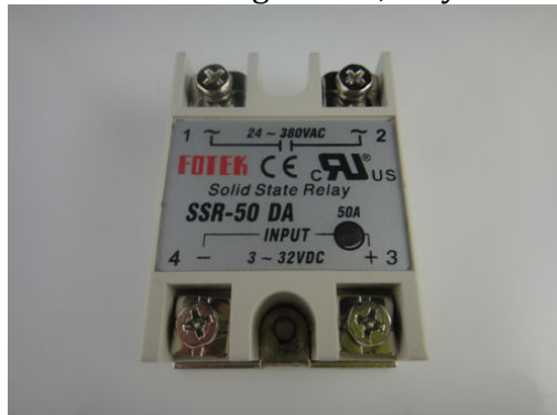
Figura 33, Relevador de estado sólido para el control de cargas eléctricas
