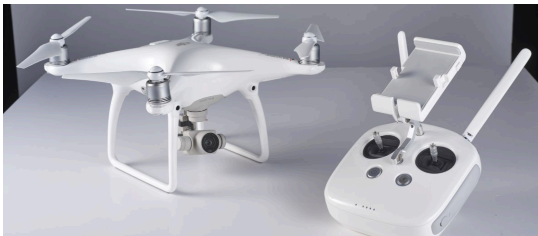
Figura 13 Imagen del VANT utilizado para realizar los vuelos. Phantom 4 de DJI GO.
