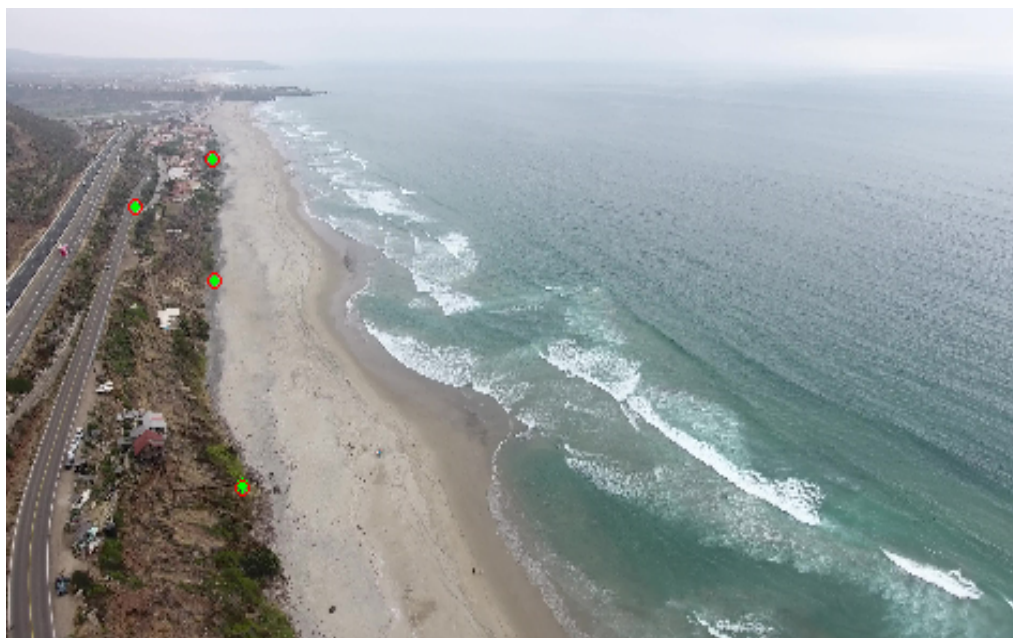
Figura 15 Puntos de control terrestres (verde) utilizados para georreferenciar todas las imágenes de un vídeo de la estación norte. Los círculos rojos indican el reconocimiento de las coordenadas UTM de la imagen para los GCP.
