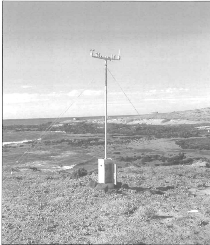
Figura 7. Estación meteorológica automatizada Aanderaa instalada al norte de Bahía San Quintín, B. C.
