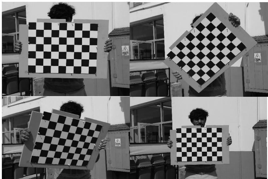
Figura 3.10 Ejemplo de tablero de calibración e imágenes tomadas para hacer el proceso de calibración intrínseca.
