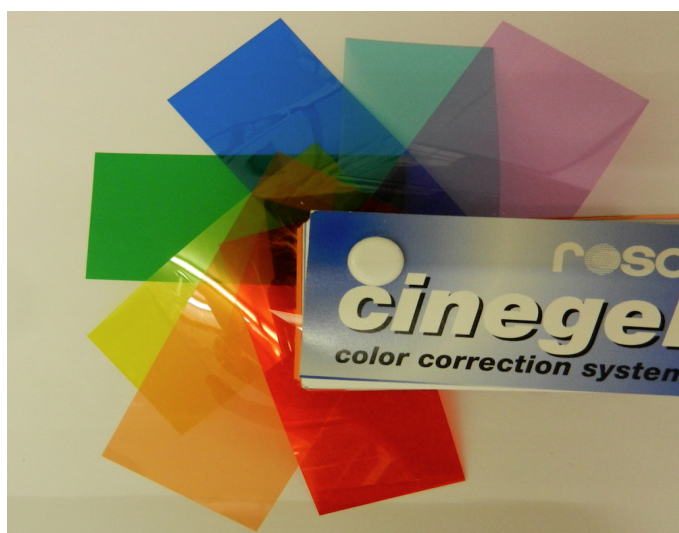
Figura 4.34: Estándar de colores para la calibración del colorímetro.
