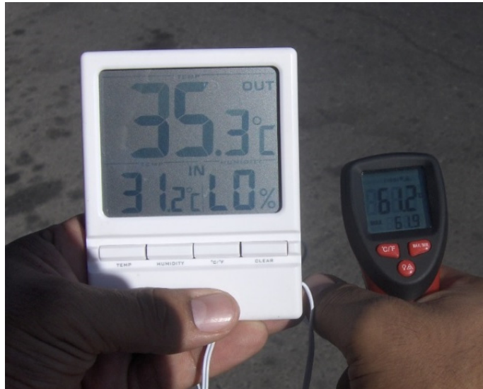
Figura 118. Temperatura de la superficie de la calle a temperatura ambiental
