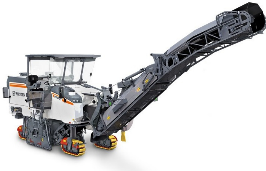
Figura 17. Fresadora con barredoras en los procesos en frío (Wirtgen, 2018 B)
