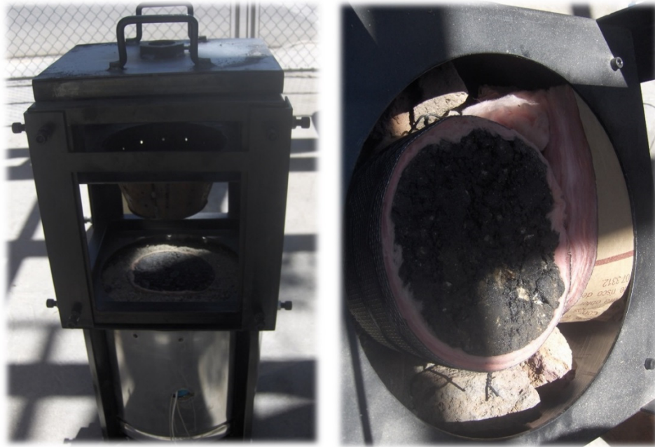
Figura 117. Colocación de la muestra asfáltica en el horno
