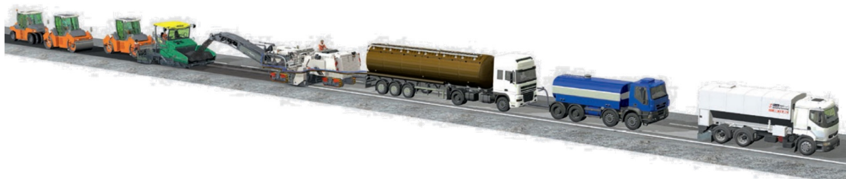
Figura 21. Proceso de reciclaje en frío en sitio (Wirtgen, 2017)
