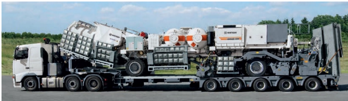
Figura 105. Remix 4500 forma de transportación (Wirtgen, 2016 C)
