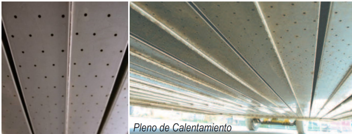
Figura 36. Vista inferior de la cámara de calentamiento de la máquina AR2000 (Martec, 2018)
