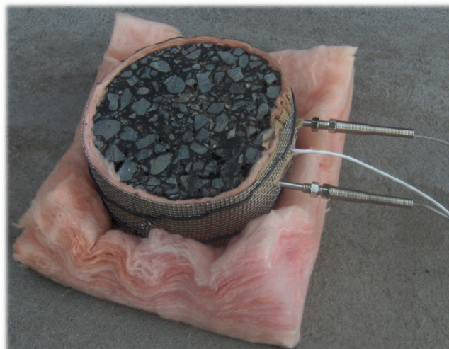
Figura 116. Aislamiento de la cara inferior de la muestra asfáltica
