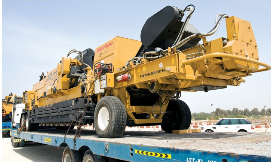
Figura 47. Compactación del AR2000 para ser transportado a otro sitio
