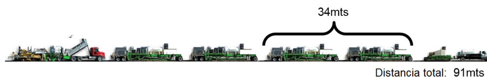
Figura 108. Ecopave 400 Máquinas que se requieren agregar para un corte a 100 mm
