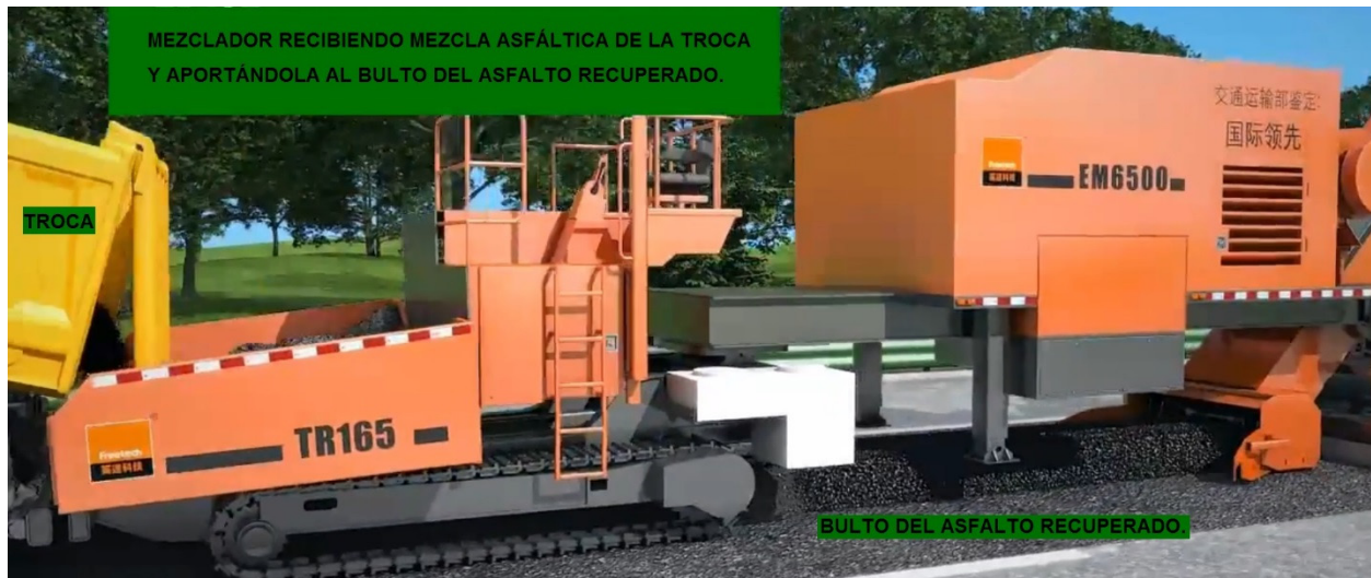
Figura 62. TR165 Tractor oruga para aportar una nueva mezcla asfáltica al bulto recuperado (Fretech, 2014)
