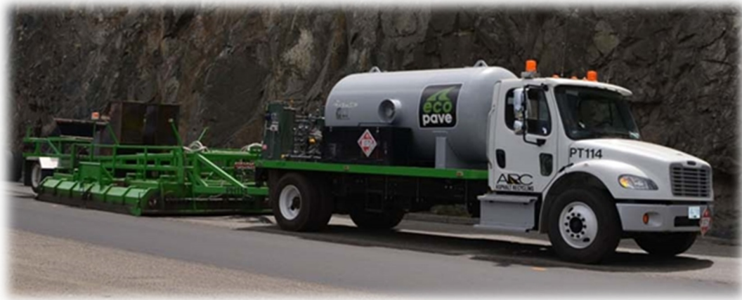
Figura 72. Pre calentador de Ecopave (Ecopave, 2018)
