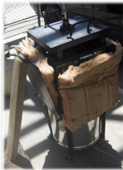
Figura 119. Aislamiento de las paredes del horno
