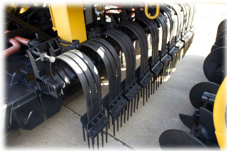
Figura 27. Dedos escarificadores para rasgar el pavimento asfáltico en un proceso en caliente (BENEDETTI, n.d.)
