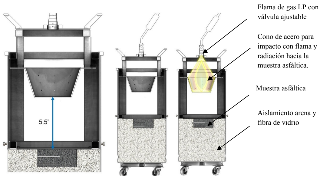
Figura 111. Zona de calentamiento del horno para las pruebas
