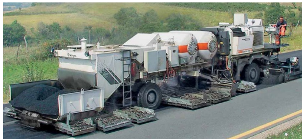
Mixer 4500 en operación y con camas extendidas
