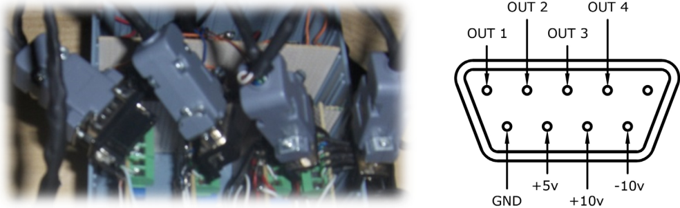
Figura K conexiones entre tarjetas por medio del conector DP9
