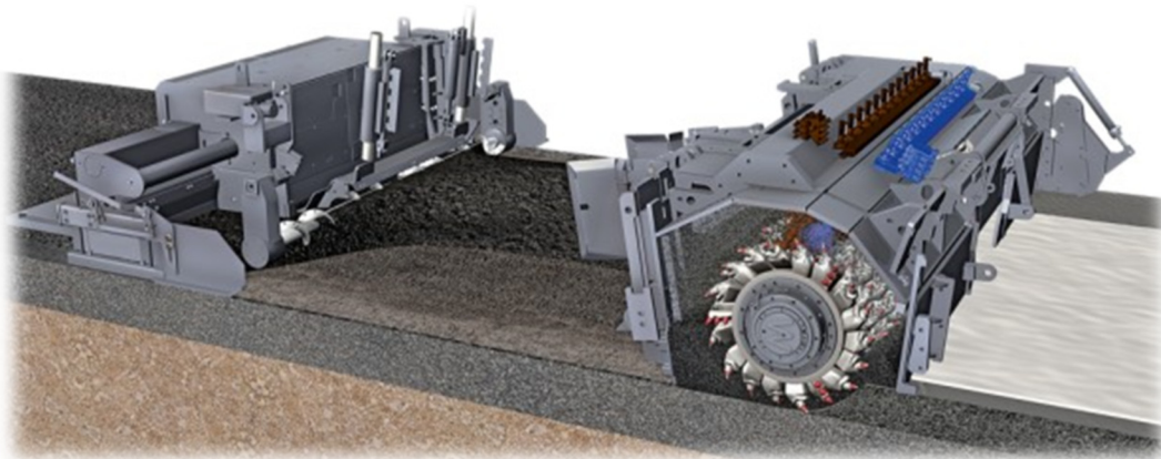
Figura 14. Esquema en 3ra dimensión de fresado de pavimento (Wirtgen, 2004)
