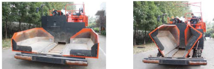
Figura 61. Tolva móvil del TR165, para agregar mezcla asfáltica a la obra (Freemove, 2014)
