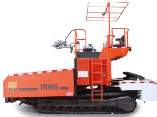
Figura 60. TR165 Oruga tractor para agregar mezcla asfáltica (Freemove, 2014)
