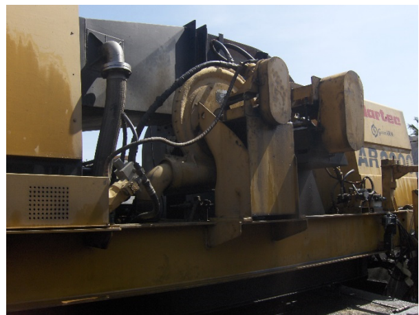
Sopladores del sistema de quemador
