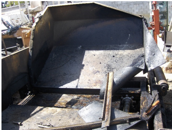
Tolva para recibir la mezcla asfáltica nueva
