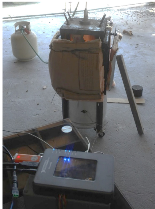
Figura 127. Pruebas de calentamiento con el nuevo sistema de MyRIO®
