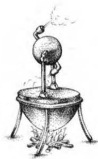
Aelopila. Dispositivo que genera movimiento con la fuerza del vapor.
