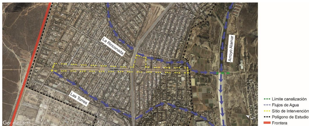
Figura 103. Flujos de agua cercanos a la zona de intervención.
