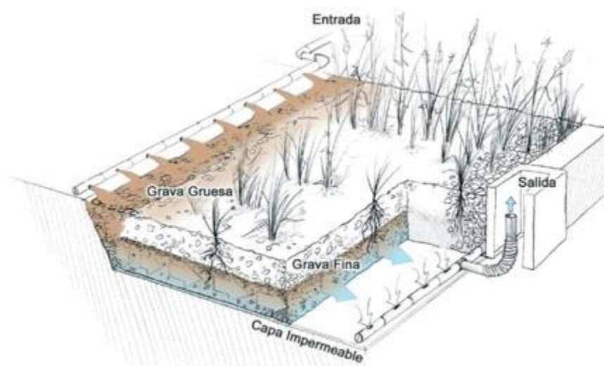
Figura 61. Esquema general del funcionamiento y elementos de un humedal artificial.
