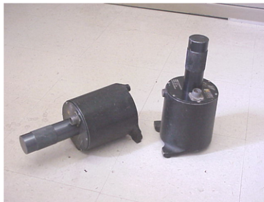
Figura 12. Acelerómetros WR-1 de la marca Kinemetrics.
