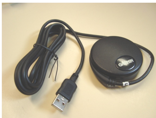
Figura 8. GPS18 con conector USB.
