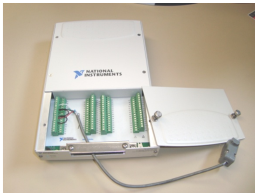
Figura 7. Módulo de adquisición de datos.
