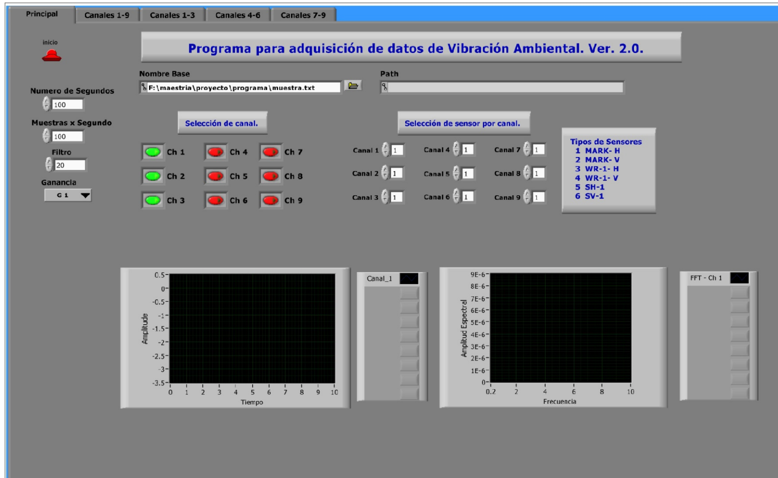
Figura 42. Carátula principal con control de ganancia y frecuencias de corte de filtro digital.
