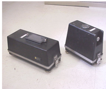
Figura 10. Sismómetros de la marca Kinematics modelos SH-1 y SV-1.
