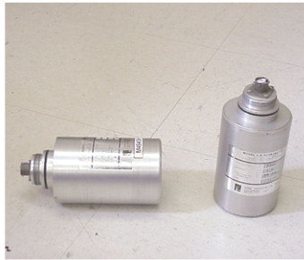
Figura 9. Sismómetros de la marca Mark modelo L-4.
