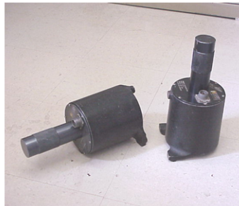
Figura 11. Sismómetros WR-1 en modo de velocidad de Kinematics.
