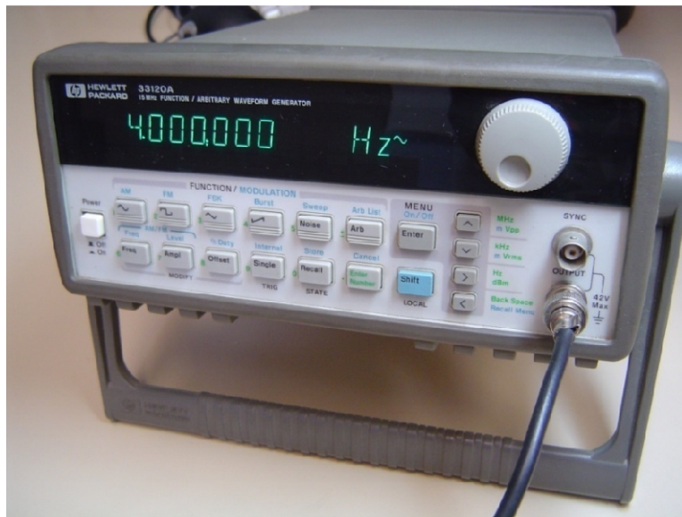
Figura 20. Generador de funciones HP 33120A.
