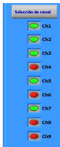
Figura 35. Interruptores para la selección de canales a utilizar en la medición.
