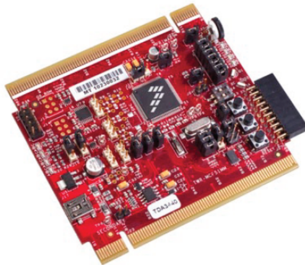
Figura 5.3: Microcontrolador de 32 bits MCF51MM256 utilizado en el trabajo experimental de este trabajo de tesis.
