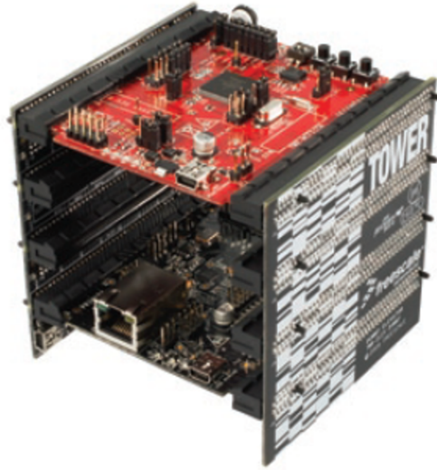
Figura 5.2: Torre TWR-MCF51MM utilizada para trabajar con el microcontrolador MCF51MM256.
