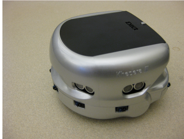
Figura 3.7 Robot móvil diferencial Khepera III, Laboratorio de Sincronización y Sistemas Complejos.
