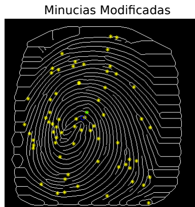
Figura 7.7: Minucias de Huella dactilar 101_8; minucias (amarillo y verde), punto de referencia (azul).
